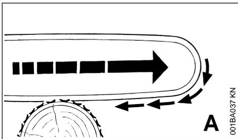
Si lorsqu'on coupe avec le côté inférieur du guide-chaîne – coupe sur le dessus – la chaîne se coince ou touche un corps étranger noyé dans le bois, la tronçonneuse peut être brusquement attirée vers le tronc – **pour travailler sur du bois qui ne risque pas d'être endommagé, STIHL recommande de monter la griffe proposée pour le post-équipement et de bien caler la tron-**
