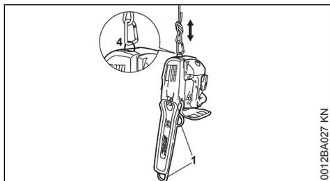
Pour transporter la tronçonneuse et l'assurer avec une corde, toujours utiliser l'anneau escamotable (4) prévu au dos de la machine.
