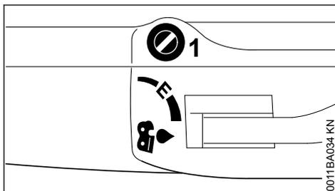
Le boulon de réglage (1) situé sur la face supérieure de la machine permet de régler le débit d'huile suivant besoin.
