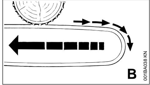
Si lorsqu'on coupe avec le côté supérieur du guide-chaîne – coupe par le dessous – la chaîne se coince ou touche un corps étranger noyé dans le bois, la tronçonneuse peut être repoussée en arrière, en direction de l'utilisateur – **pour éviter ce phénomène :**
